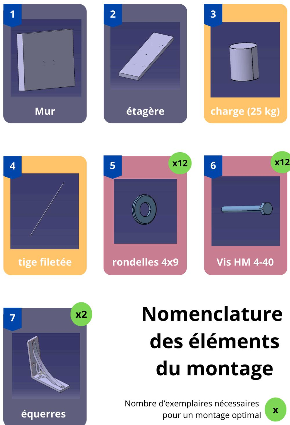
Figure 8 : Inventaire par le biais d'une nomenclature des différents éléments nécessaire au montage de l'assemblage
